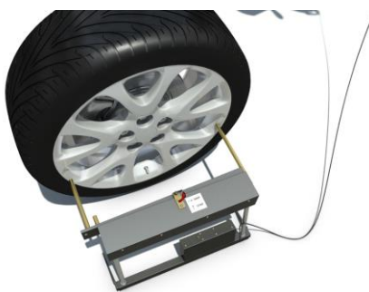
Рис.40. Фиксация опорной планки ДМТ в положении "ЗАКР"
