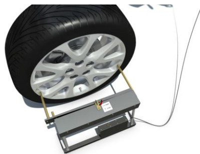
Рис. 32. Установка датчика момента трогания (ДМТ) к плоскому участку поверхности диска управляемого колеса в положении «ОТКР»
