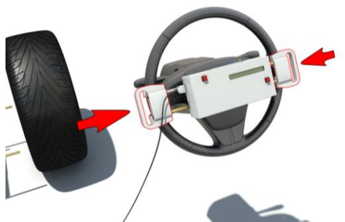
Рис. 29. Установка основного блока (ОБ) на внешнем ободе рулевого колеса
