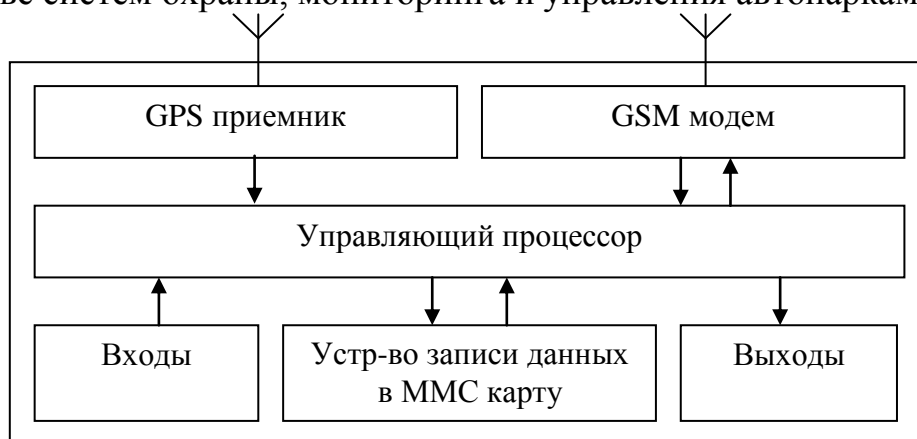
Рис. 21. Схема аппаратуры “Шкипер”
