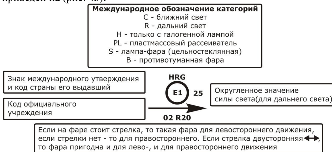
Рис. 43. Пример маркировки фары
