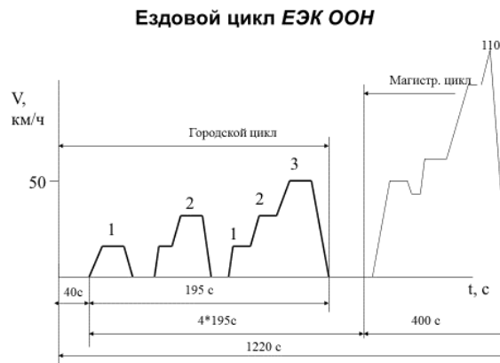
Рис.49. Ездовой цикл согласно требованиям ЕВРО-1,2 (для ездового цикла ЕВРО-3,4,5,6 режим прогрева ДВС в течении 40 с ликвидируется)
