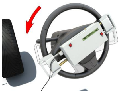
Рис. 35. Вращение рулевого колеса до положения РУ "Люфт замерен = ..."
