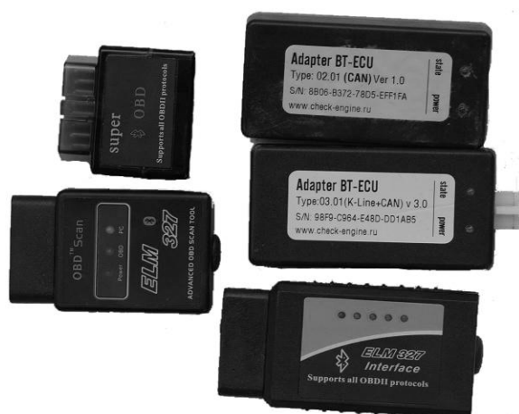
Рис. 5.16. OBD-2 адаптеры на базе чипа ELM327
