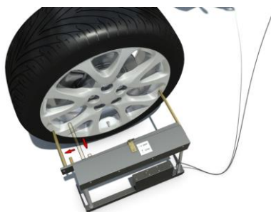
Рис. 31. Установка упора 5 до касания аналогичного участка диска колеса с другой стороны
