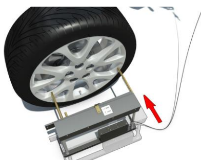
Рис. 30. Установка датчика момента трогания (ДМТ) к плоскому участку поверхности диска управляемого колеса в положении «ЗАКР»
