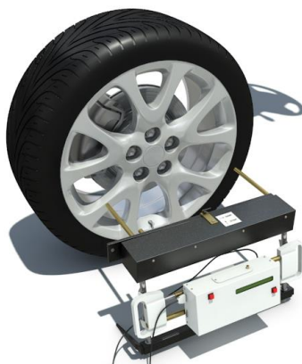
Рис. 27. Установка прибора ИСЛ-401 на посту
