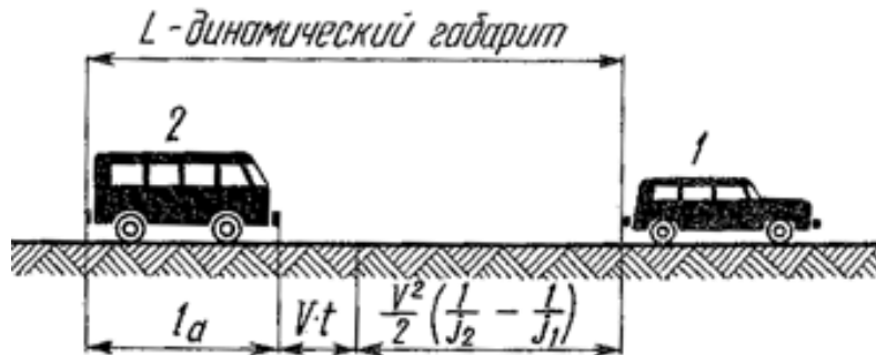
Рис. 6. Схема к определению динамического габарита автомобиля
